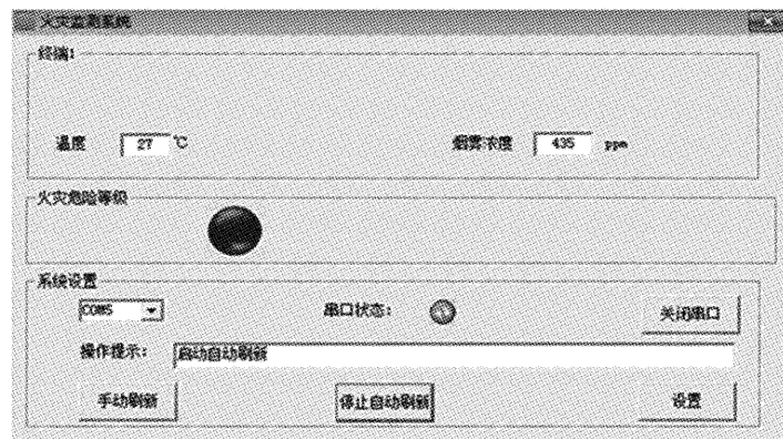
图 9 无火灾发生时的监控结果
