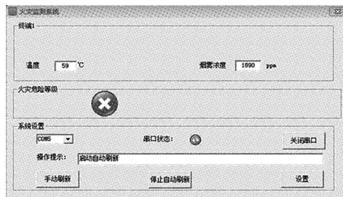
图 10 有火灾发生时的监控结果
